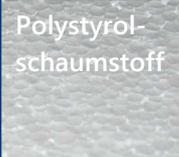
Polystyrolschaumstoff | <ul style="list-style-type: none"> <li>– leicht zu verarbeiten</li> <li>– feuchtigkeits- &amp; frostbeständig</li> <li>– preiswert</li> </ul>                                  | <ul style="list-style-type: none"> <li>– hoher Energiebedarf zur Produktion nötig</li> </ul>                  | Dach, Wand, Fußboden         |
