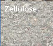
Zellulose             | <ul style="list-style-type: none"> <li>– preiswert</li> <li>– schimmelresistent</li> <li>– schädlingsresistent</li> <li>– sehr gute Schalldämmung</li> </ul>                   | <ul style="list-style-type: none"> <li>– nicht druckbelastbar</li> <li>– Entsorgung problematisch</li> </ul>  | Dach, Decke, Wand            |
