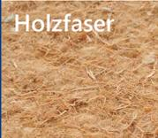
Holzfaser             | <ul style="list-style-type: none"> <li>– druckbelastbar</li> <li>– guter sommerlicher Wärmeschutz</li> <li>– feuchteregulierend</li> </ul>                                     | <ul style="list-style-type: none"> <li>– teuer</li> </ul>                                                     | Dach, Decke, Wand, Fußboden  |
