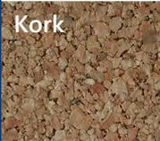
Kork                  | <ul style="list-style-type: none"> <li>– hoch belastbar</li> <li>– gute Wärme- &amp; Schalldämmung</li> <li>– fäulnis- &amp; schädlingsresistent</li> </ul>                    | <ul style="list-style-type: none"> <li>– begrenzter Rohstoff</li> <li>– teuer</li> </ul>                      | Dach, Decke, Hohlräume, Wand |
