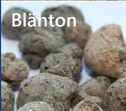
Blähton               | <ul style="list-style-type: none"> <li>– feuchtigkeits- &amp; frostbeständig</li> <li>– nicht brennbar</li> <li>– gute Schalldämmung</li> <li>– schädlingsresistent</li> </ul> | <ul style="list-style-type: none"> <li>– hoher Energiebedarf zur Produktion nötig</li> </ul>                  | Decke                        |
