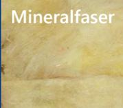
Mineralfaser            | <ul style="list-style-type: none"> <li>– gute Wärme- &amp; Schalldämmung (nicht brennbar)</li> <li>– schimmelresistent</li> </ul>                                              | <ul style="list-style-type: none"> <li>– hoher Energiebedarf zur Produktion nötig</li> </ul>                  | Dach, Wand, Fußboden         |
