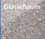
Glasschaum            | <ul style="list-style-type: none"> <li>– feuchtigkeits- &amp; frostbeständig</li> <li>– hoch belastbar</li> <li>– schädlingsresistent</li> <li>– nicht brennbar</li> </ul>     | <ul style="list-style-type: none"> <li>– hoher Energiebedarf zur Produktion nötig</li> <li>– teuer</li> </ul> | Erdbereich, Keller           |
