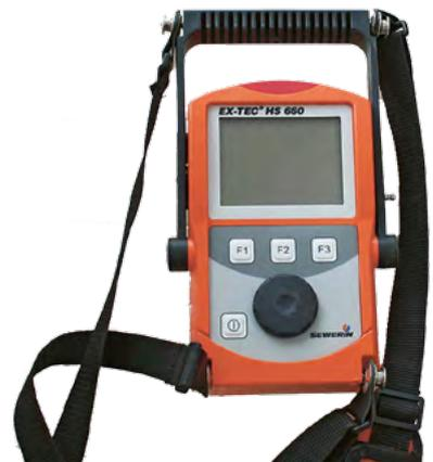
1 Das Gasspürgerät zeigt die am Boden aufgenommenen Daten an. Fotos (3): SPREE-PR/Hultzsch
