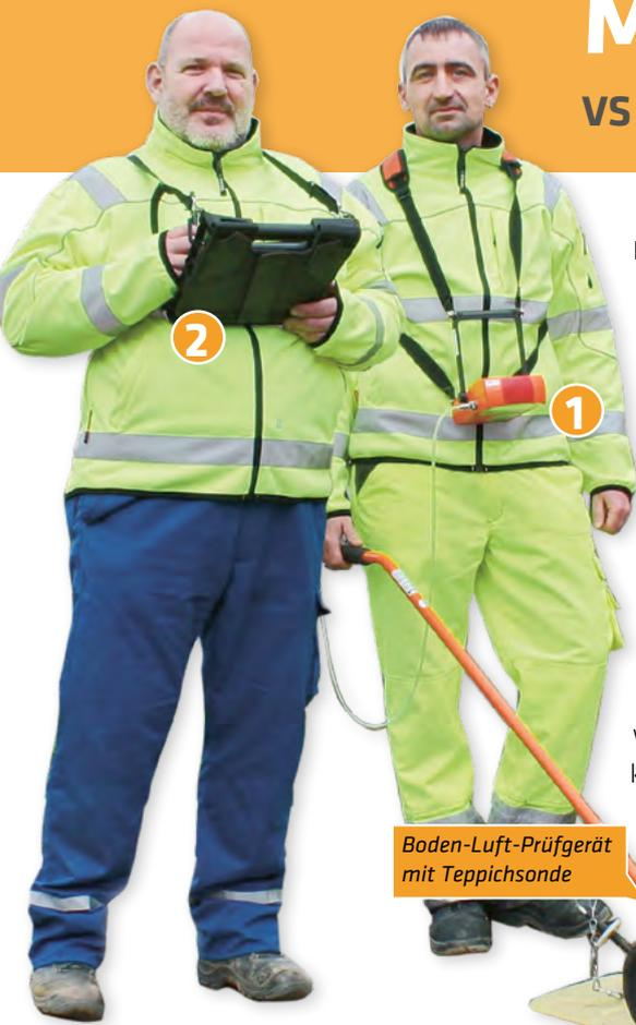
Boden-Luft-Prüfgerät mit Teppichsonde
