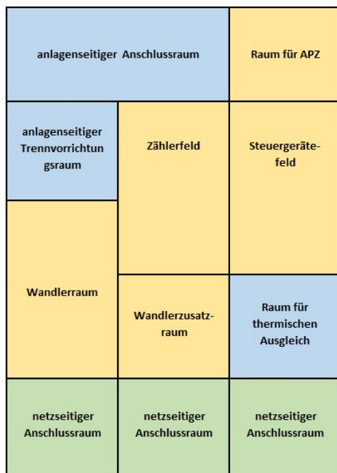
Abbildung 14: Wandlermessung - Anwendungsbeispiel 200 A
