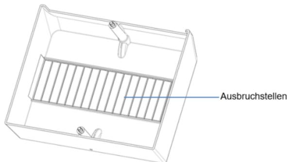
Er verfügt auf der Innenseite über Ausbrüche, die Sie mit Hilfe eines Schraubendrehers einzeln herausbrechen können.
