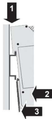
1. Hängen Sie das Zusatzgerät mit der oberen Rasterführung auf der oberen Kante der Hutschiene ein.
