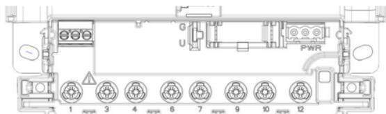
Klemmenblock von vorne für Zähler mit direktem Anschluss bis 60 A
