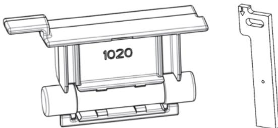
Sicherungshalter mit Sicherung und Steckbrücke
