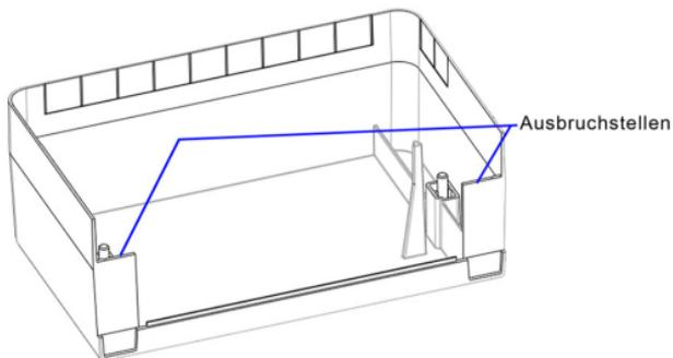
Zur Durchführung der Kabel vom Klemmenblock zum Modulfach lassen sich die vorgeprägten Ausbruchstellen herausbrechen.
