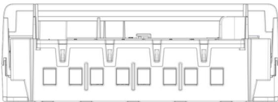
Klemmenblock von unten für Zähler mit direktem Anschluss bis 60 A
