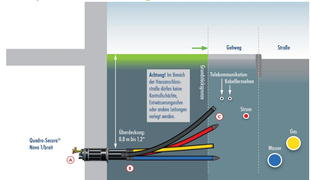
Die dargestellten Hauseinführungssysteme sind für folgende Kabel oder Rohrquerschnitte geeignet:
